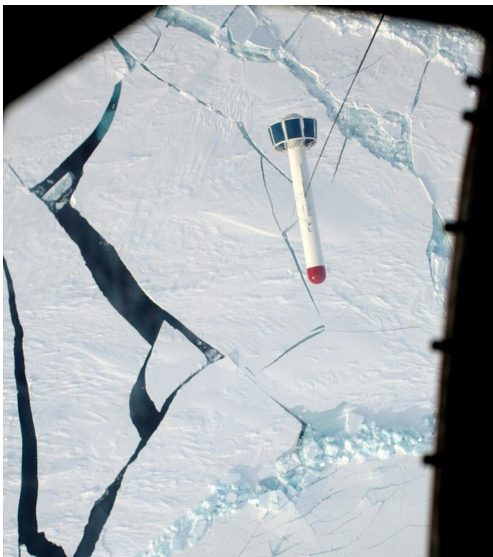
Foto: Bedre teknologi, målemetoder og tilgang til data, for eksempel gjennom bruk av måleinstrumenter som "EM Bird" som henger under fly, gir styrket tiltro til vurderingene av endringer og trender i havisen i Arktis.
